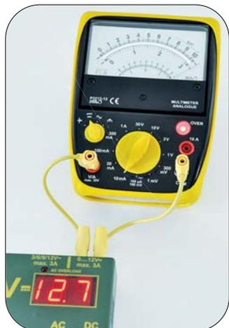
Elektronischer Überlastschutz in allen Messbereichen, mit Kontroll-LED-Anzeige (keine Schmelzsicherungen mehr!)
