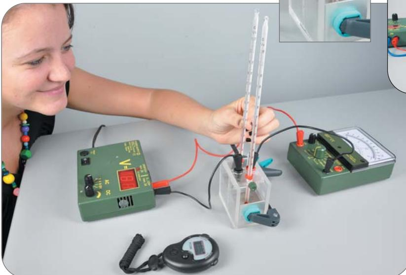
TDS 5.2 Thermoelektrische Kühlung, „Peltier Effekt“
