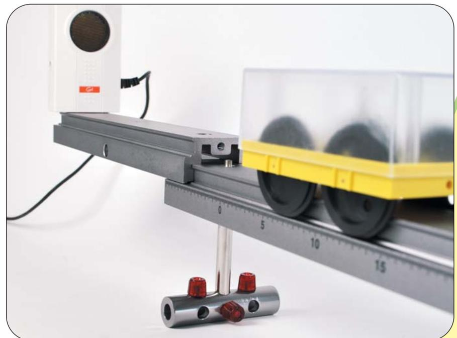
Gleichmäßig beschleunigte Bewegung (s/t- und v/t-Diagramm)
