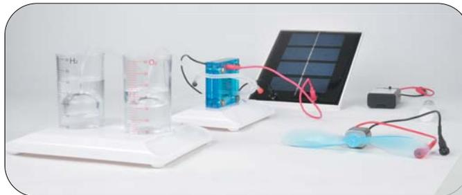
Die Energiezufuhr zur Erzeugung von Wasserstoff erfolgt durch das Solarpanel und den Batteriekasten. Mit dem erzeugten Wasserstoff kann dann durch die Brennstoffzelle der Motor betrieben werden.
