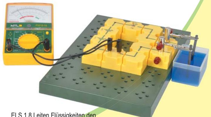
ELS 1.8 Leiten Flüssigkeiten den elektrischen Strom?
