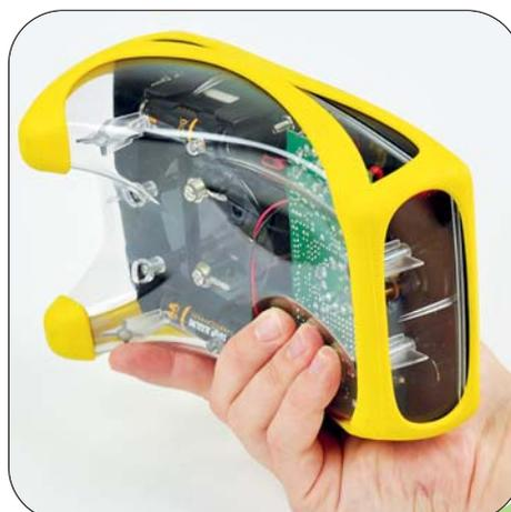
Transparenter Boden mit Griffmulde zur Halterung mit einer Hand
