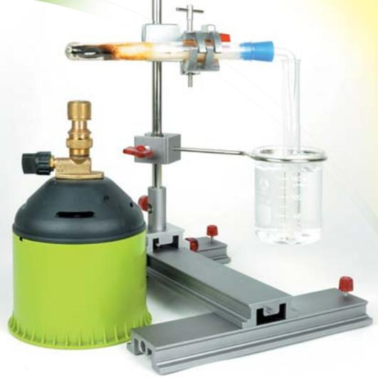
Der aus NTL-Alu-Sonderprofil angefertigte und eloxierte H-Fuß ist sehr stabil, bildet eine relativ schwere und solide Standfläche und ist weitgehend chemikalienbeständig. Durch den flexibel montierbaren Reiter lässt sich der Aufbau auf dem H-Fuß beliebig positionieren.
