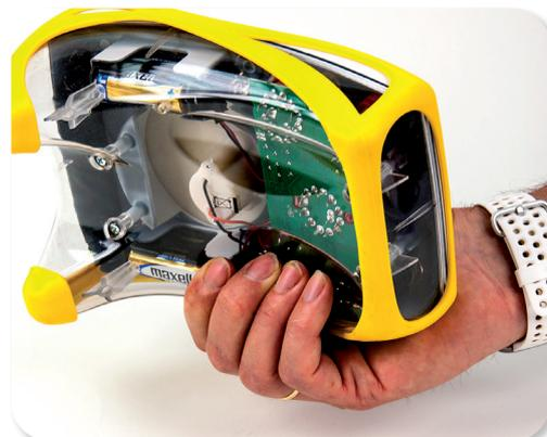
Transparenter Boden mit Griffmulde zur Halterung mit einer Hand
