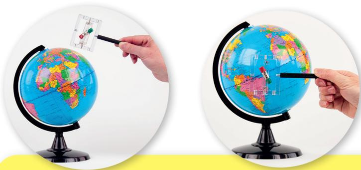
Die Inklination wird durch das "Ertasten" der Magnetfeldlinien um die Erde selbst erklärt
