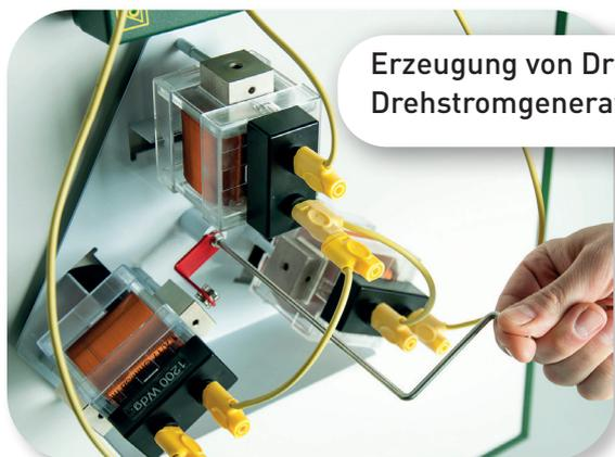
Erzeugung von Drehstrom - Drehstromgenerator
