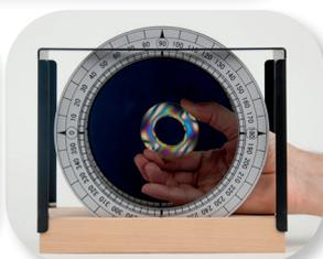
Spannungsverteilung an Kanten, Rundungen sowie an einem Ring
