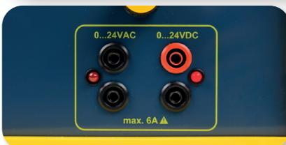
LED-Indikator zur Anzeige des aktiven Ausgangs-Buchsenpaares
